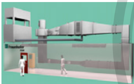
Abb. 7 // Fraunhofer IFAM-Eiswindkanal (links) mit Eis-Shedding-Test im Testfeld (Mitte) und beispielhafter vereister Testoberfläche (rechts) vor der Enteisung durch das integrierte Heizsystem.
