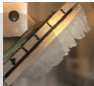
Abb. 7 // Fraunhofer IFAM-Eiswindkanal (links) mit Eis-Shedding-Test im Testfeld (Mitte) und beispielhafter vereister Testoberfläche (rechts) vor der Enteisung durch das integrierte Heizsystem.
