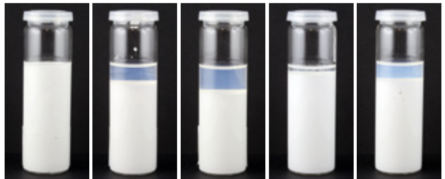
Abb. 6 // Absetzneigungsvergleich. Proben mit (v.l.) MHEC, Additiv 1, Marktstandard 1, Marktstandard 2, Marktstandard 3
